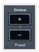
Pour rétablir le clavier à l'octave d'origine (0), appuyez simultanément sur les touches d'octave +/-. Pour rétablir la transposition originelle (0), appuyez en même temps sur les touches d'octave +/- ou sur n'importe lequel des pads 12-16.
